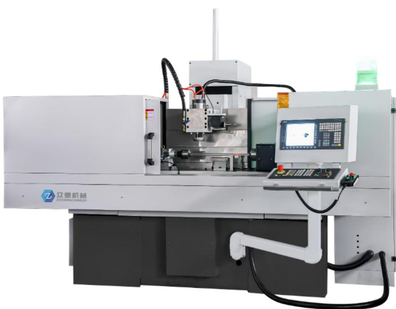
圆台数控磨床的特点：圆台数控磨床主要用于盆齿类及大型轴承套圈类零件内孔、端面磨削，保证内孔与端面的精度。是新一代高精度、高效率的生产型机床。机床整个磨削循环均自动完成，操作者只需装拆工件。圆台数控磨床用于磨削圆柱形和圆锥形小孔，亦可磨削外圆和端面。工作主轴、内圆磨头、外圆磨头均采用油雾润滑。圆台数控磨床系统编程功能较强，操作简单易学，并具有多种适应磨削加工要求的特殊功能，可满足用户对多种零件的加工需要。安徽动柱式数控磨床供应厂家安装数控磨床前，先要去除磨床上的防锈油，然后才能开始进行操作。
